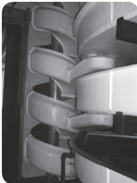
De spiraalvormige glijbaan waarover de vissen vanuit de bassins (rechts) naar de verzamelput glijden om daarna gesorteerd te worden.
