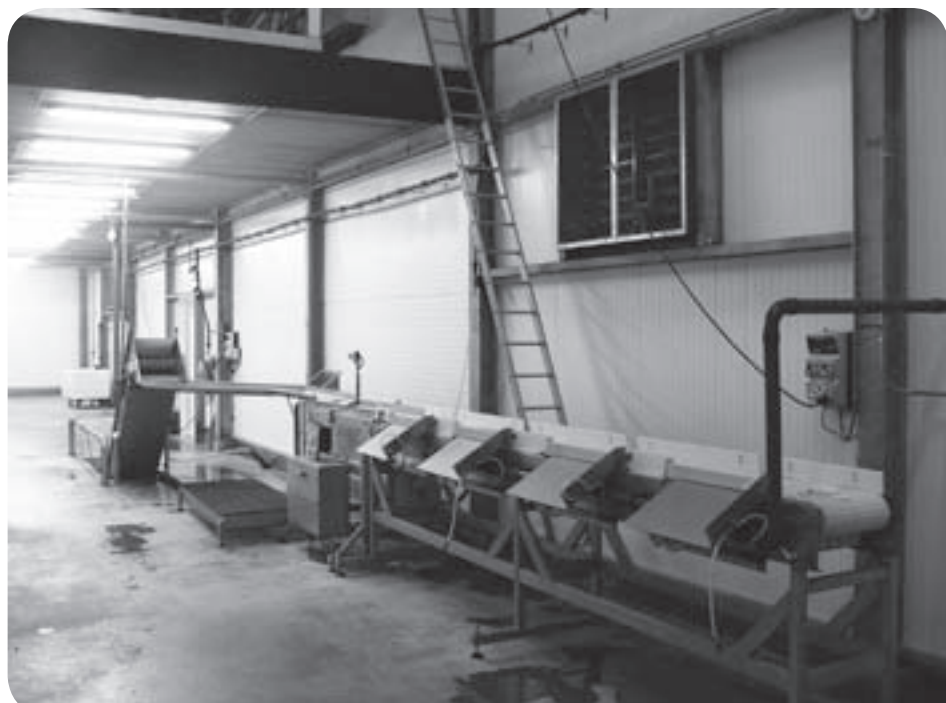
Sorteermachine met achteraan de transportband waarmee de vissen vanuit de verzamelput op de sorteermachine worden gebracht. Foto: Seafarm.
