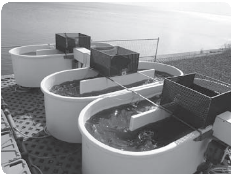
Rondstroombakken worden gebruikt voor algenkweek in het onderzoek naar de optimale voeding van schelpdieren
