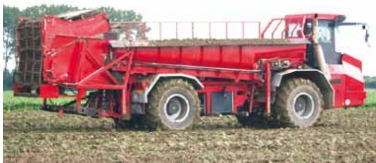
◀ Tijdens het transport kan de afvoer helemaal naar binnen worden geklapt. Bij de auto's haalt deze een hoogte van ruim 4,50 meter.
