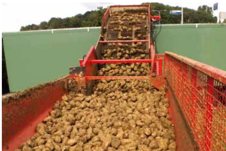
◀ De overlaadwagen is opgebouwd met veel elementen uit de Holmer-rooier. Door recht naar achteren te lossen, ontstaat een mooie, vloeiende stroom bieten.
