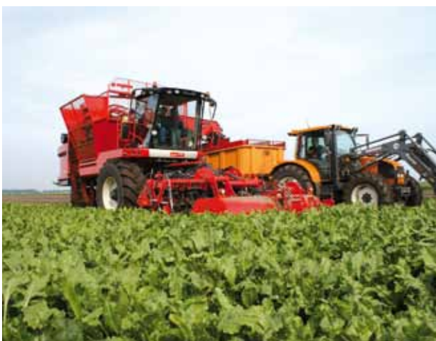
◀ De twaalftons tussenbunker is groot genoeg om de tussentijden van het transport te overbruggen. In combinatie met rijdend lossen haalt deze machine een Big Six-capaciteit.
