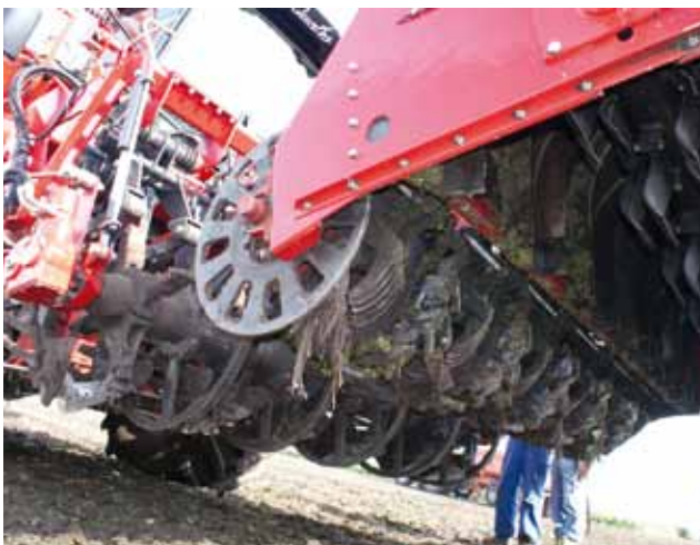
◀ Het nieuwe, snellere ExcenterPlus-rooisysteem met dieptewielen, invoerrotors, meer gebogen rooischaren en horizontaal zelfzoekend opgehangen rooielementen die verschuiven op de as.
