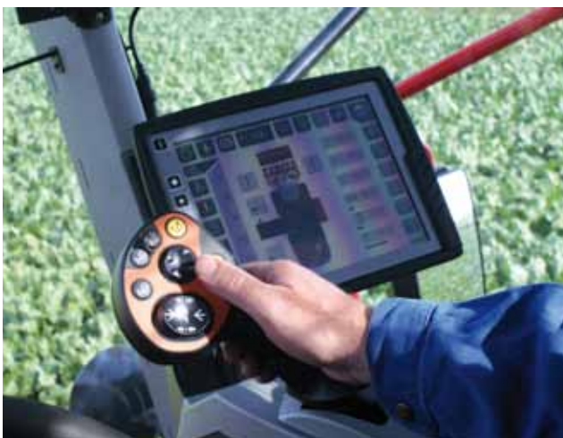
◀ De rijhendel en het EcoTronicPlus-touchscreen met de belangrijkste parameters goed in beeld. De knoppen voor de hoofdinstantellingen zitten op het rechter bedieningspaneel.
