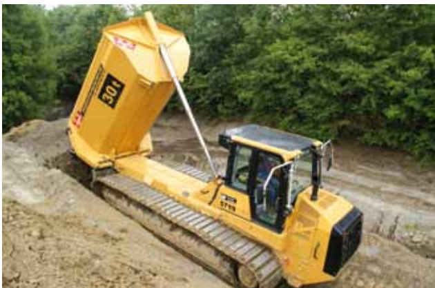
◀ De loopwerken zijn dubbel zo lang als die van de oorspronkelijke Cat 963D-rupslander en de cabine is 180 graden gedraaid.
