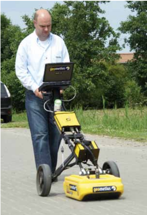
Bij de apparatuur hoort ook een laptop voor de verwerking van de gegevens. Deze is zo gemonteerd dat hij eenvoudig is mee te nemen (door de gebruiker).
