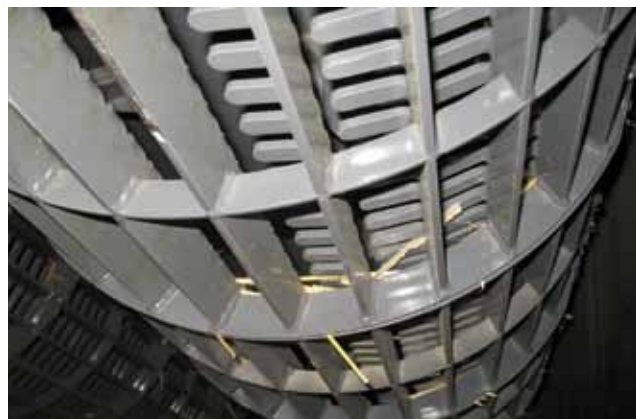
Gladde ijzeren tongen langs de wand van de rotor zorgen ervoor dat het stro gemakkelijk en vrijwel onbeschadigd kan passeren.
