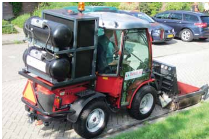
◀ Met de WeedSteam, een machine die werkt met hete lucht en stoom, verwijder je op verhardingen onkruid met rijsnelheden van drie tot vijf kilometer per uur. Berdi kiest voor de Carraro SP4400-werktuigdrager.
