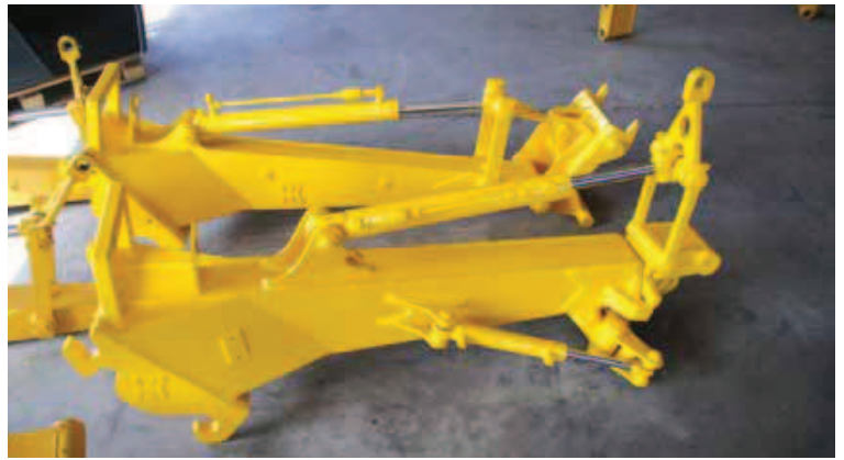
Op de voorgrond de Hobelman VLG-verlenggiel met 90-graden-kantelkop, erachter ligt een starre uitvoering van de twee meter lange giel, die - met tuimelstuk - 400 kilo weegt. Met het tuimelstuk kun je de korf in de lengterichting naast de hoofdgieel klappen.
