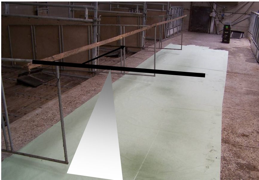
Figuur 3 Proefopstelling voor het vaststellen van het sproeipatroon van twee typen vernevelaars aan een bewegende sproeiboom
