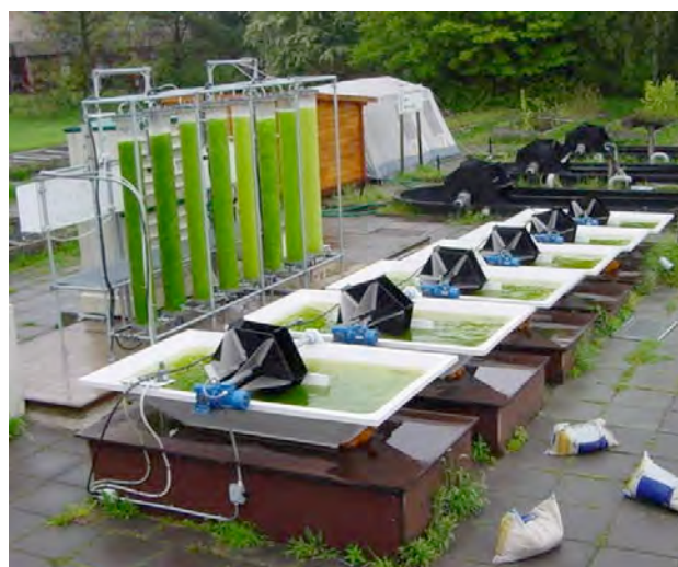
Figuur 2 Typen fotobioreactoren voor micro-algenteelt. Links: High Rate Algal Ponds, Earth Rise Farms, Californië, USA. Rechtsboven: Semi-gesloten fotobioreactor IGV, Potsdam, Duitsland. Rechtsonder: Pilot schaal cascade systeem ontwikkeld door ECN, UvA en IVAM [4].
