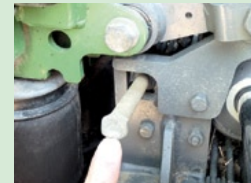
▲ Het kan zijn dat een trekker met luchtdrukberemming voor de aanhanger, ook een luchtdrukbediening heeft voor de eigen handrem. Treedt er aan de trekker onverhoopt een storing op, dan staat de trekker ook op de rem. Om dit op te lossen, kun je de handrem met een draadspindel vrijzetten om bijvoorbeeld te kunnen slepen.
