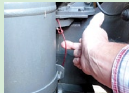
▲ De samengeperste lucht wordt opgeslagen in een voorraadvat. Hoe groter de voorraad, hoe beter de reminstallatie in staat is om veelvuldig remmen op te vangen. Het voorraadvat is de plek om vocht op te vangen. Tap daarom dagelijks het voorraadvat af door middel van het ventiel.
