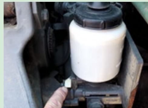
▲ Zodra de temperatuur onder de 5 graden Celsius daalt, moet je een antivriesmiddel toevoegen. Dit kan via het omzetten van een kraantje. Het is een alcoholachtige vloeistof die voorkomt dat componenten bevriezen. Wanneer de winter langer aanhoudt, moet je het reservoir aanvullen. Het middel verdwijnt uiteindelijk door verdamping.
