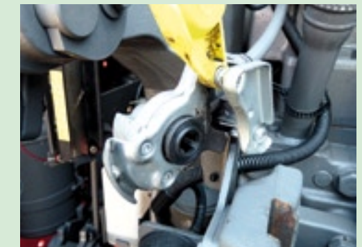
▲ De slangkoppelingen zijn nagenoeg onderhoudsvrij. Controleer altijd wel of de afdichtingen in orde zijn. Een lekkende remslang betekent verlies van lucht en dus capaciteit. Ook de afdichtrubbers van de aanhanger dienen te worden gecontroleerd en zo nodig te worden vervangen.
