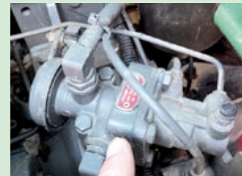
▲ Het aanhangerstuurventiel zorgt ervoor dat de aanhanger een fractie eerder wordt geremd dan de trekker. Dit voorkomt het scharen van de combinatie. Deze afstelling is door de fabrikant ingesteld en kan de gebruiker niet aanpassen. Merk u dat de trekker eerder remt dan de aanhanger, dan dient de afstelling te worden gecontroleerd door uw serviceagent.
