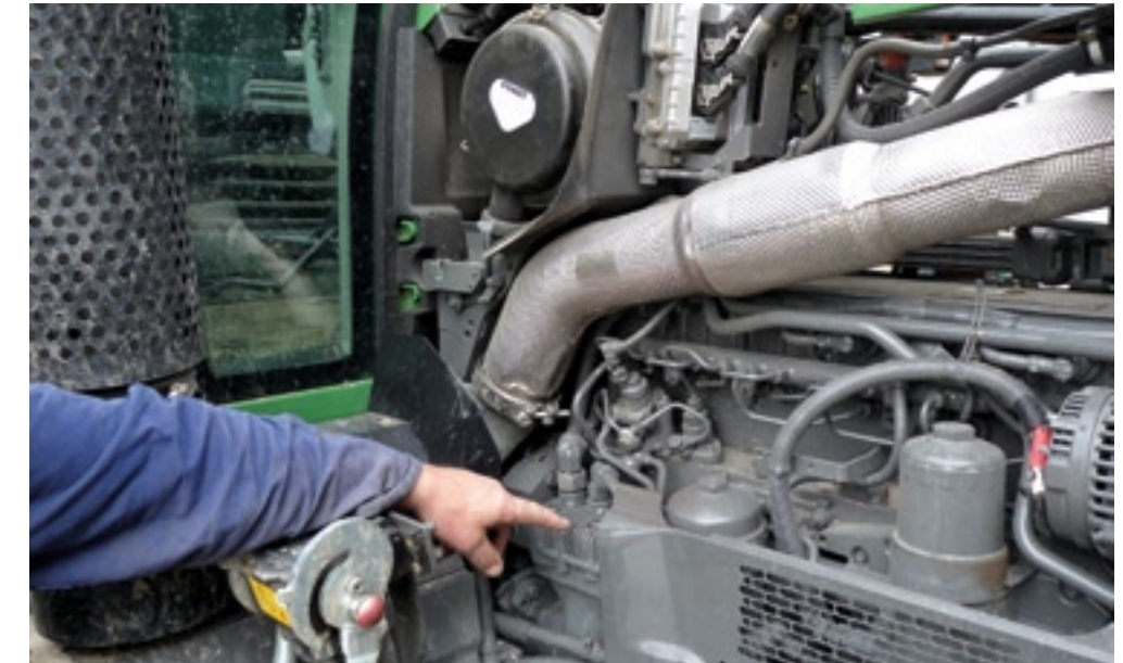
▲ Op moderne trekkers is de compressor vaak al af-fabriek opgebouwd. De aandrijving loopt via de distributiewielen. Het spannen van een V-snaar is daarmee overbodig geworden. De smering gaat via het smeersysteem van de motor. De compressor zuigt aan uit het luchtfilter van de motor. Zorg ervoor dat het luchtfilter altijd schoon is en reinigt volgens voorschrift.
