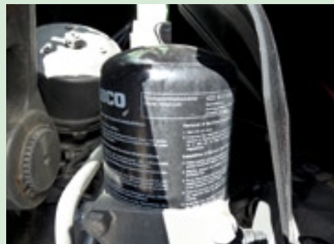
▲ Door het samenpersen van lucht daalt de condensatietemperatuur. Hierdoor kan zich vocht ophopen in het remsysteem. Om dit te voorkomen wordt een luchtdroger toegepast. Deze luchtdroger kan regenereren. Vervang de droger volgens voorschrift of zodra er bij het ontluften van de lucht tanks vocht ontsnapt.
