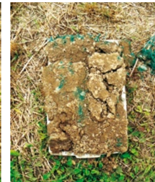
▲ Bij directzaai verbetert de bodemstructuur tot op grote diepte. Foto's van een proef Zwitserland: foto links tien jaar directzaai, foto rechts tien jaar alleen oppervlakkige bewerking. Om de poriën zichtbaar te maken, is gebruik gemaakt van een blauwe kleurstof. Het profiel van de directzaai is losser en homogener, bij de oppervlakkige bewerking is duidelijk te zien dat het profiel minder mooi van opbouw is. In de directzaai-proeven waren er ook duidelijk meer wormen aanwezig.
