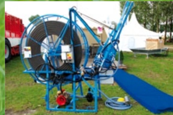
▲ S-S Engineering lanceerde een slimme drainreiniger: de Professional ARS (Automatic Repeed System). Als de weerstand in de drain te hoog wordt, gaat de oliedruk omhoog en trekt de drainreiniger automatisch de slang terug. Je kunt instellen hoe lang hij dit doet: van 0 tot 12 seconden, wat overeenkomt met 5 cm tot 5 meter. Er klinkt dan een claxon. De machine is op afstand te bedienen en kost 14.000 euro.
