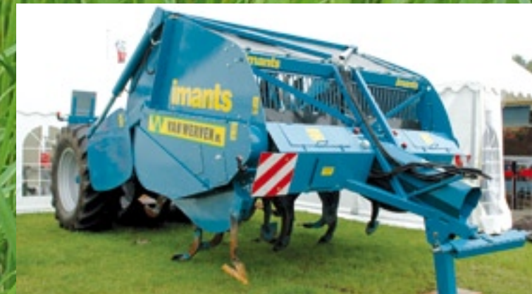
▲ Imants maakte voor loonbedrijf Van Werven in Oldebroek een 3 meter brede spitmachine die tot 135 cm diep werkt. De machine is net geen 3,5 meter breed en wordt aan de achterzijde gedragen door vier banden, maat 650/65R38. De spitorotor wordt tweezijdig aangedreven. De machine kost ongeveer een ton.
