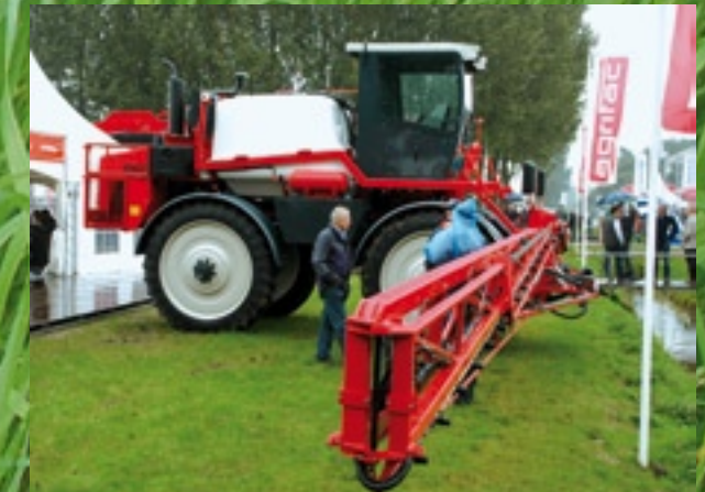
▲ Agrifac toonde de Eagle frontspuit. Op deze hydrostatisch aangedreven zelfrijder met een tank van 2.700 liter passen bomen van 27 tot 29 meter. De boomhoogte kan variëren van 50 tot 230 cm. Standaard is vierwielbesturing. De topsnelheid is 45 km/h, de krachtbron een 93 kW (125 pk) Deutz.
