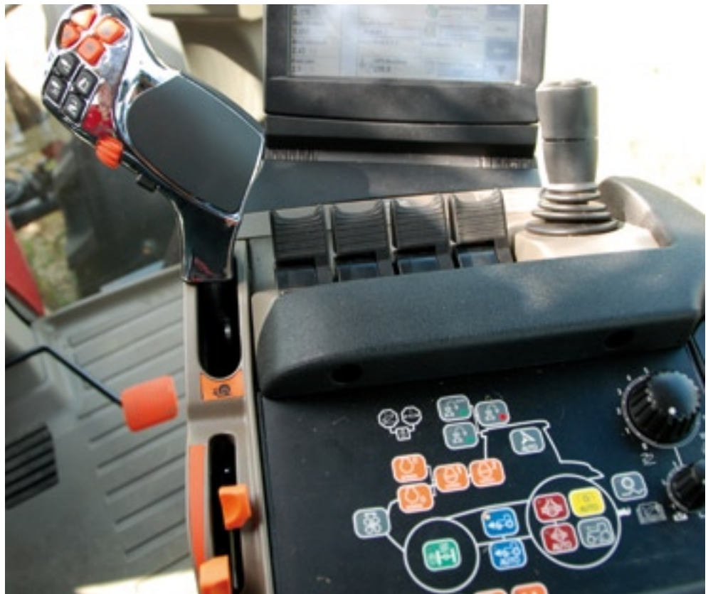
▲ Case IH's MultiController. Op de hendel vind je knoppen voor de bediening van de hef, hydraulische cilinder en voor- en achteruit. Met de draaiknop stel je de rijsnelheid in. Onder de hendel het dubbele handgas.
