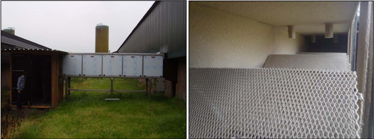
Figuur 1 Prototypen van het ionisatiesysteem. Links: opstelling van het systeem nageschakeld aan een kooistal. Rechts: binnenzijde van het systeem. Aan het plafond zijn twee isolatoren zichtbaar waarin de dunne ionisatiedraden hangen (niet zichtbaar), op de bodem gearde profielen van draadgazen voor stofafvang.
