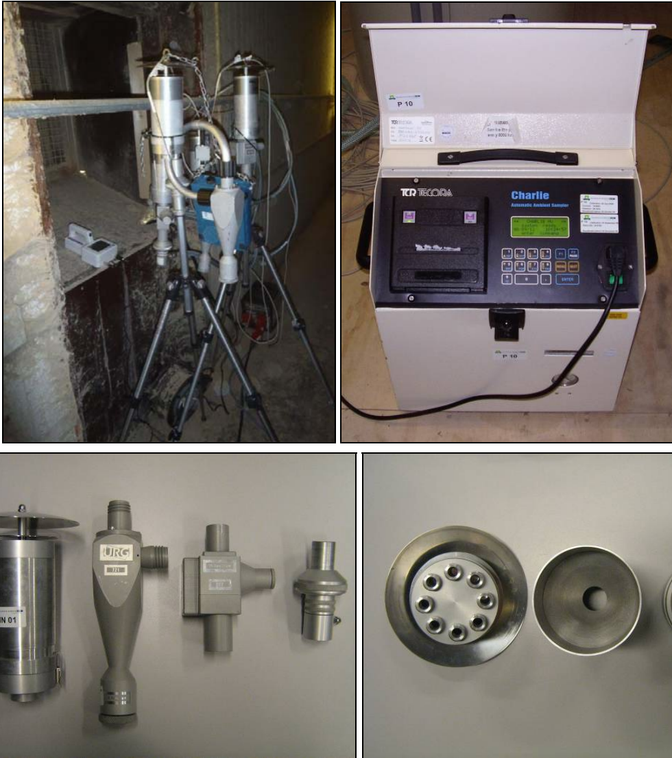
Figuur 2 Linksboven: meting van de ingaande lucht van het ionisatiesysteem. Rechtsboven: de 'constant flow' monsternamepomp voor fijnstofbemonstering. Linksonder: monsternamekoppen voor PM10 en PM2,5 met (van links naar rechts): inlaat, PM10 cycloon, PM2,5 cycloon en filterhouder. Rechtsonder: de constructie van de inlaat.
