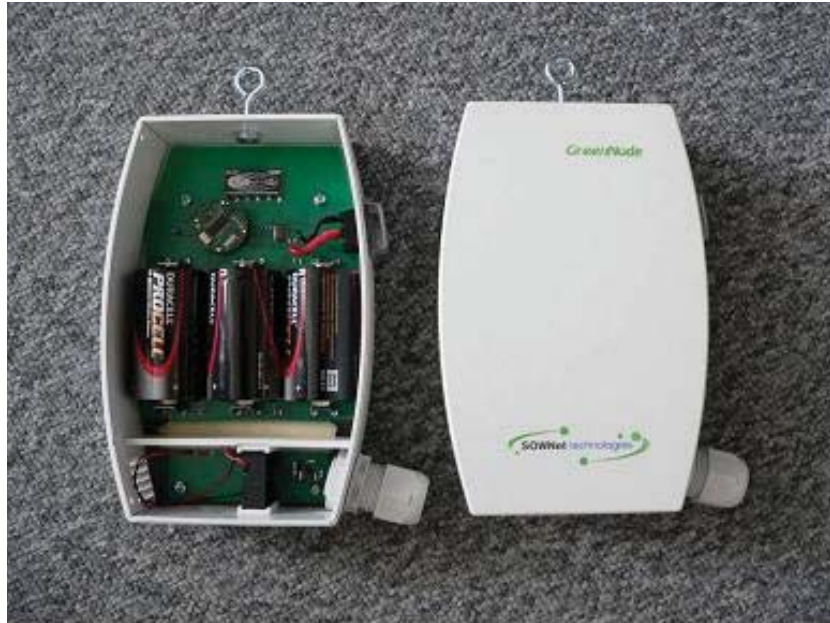
Figuur 3. Foto van de gebruikte sensor ten behoeve van de temperatuur en relatieve luchtvochtigheidsmeting.
