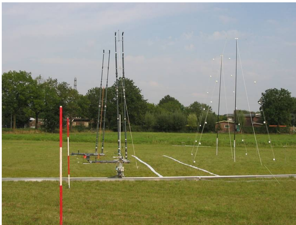
Figuur 2. Opstelling van de masten voor actieve (links) en passieve (rechts) meetmethode aan weerskanten van de 2 parallelle rijen collectoren voor drift naar de grond.
