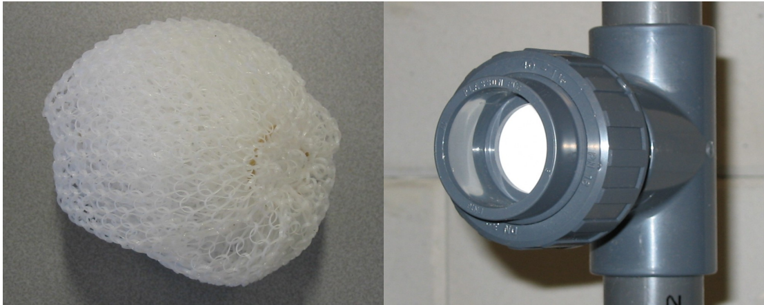
Figuur 3. Passieve collector (links) en actieve collector (rechts).
