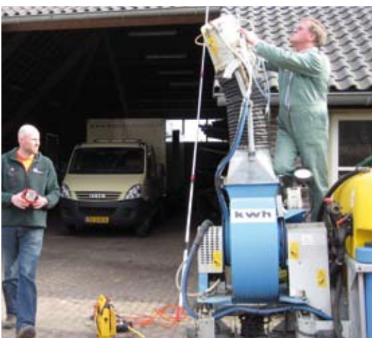
Mengen van de componenten komt zeer nauw. Vanuit de buiten- en binnentank moeten de componenten samen met het water en de nematoden een perfect filmpje vormen in de lucht voordat het op de boom terecht komt.
