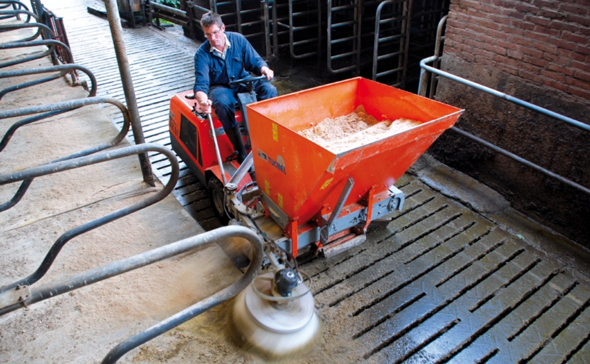
De bediening. Voor de kruishendel zit een draaiknop om de hydrostaat te smoren.
