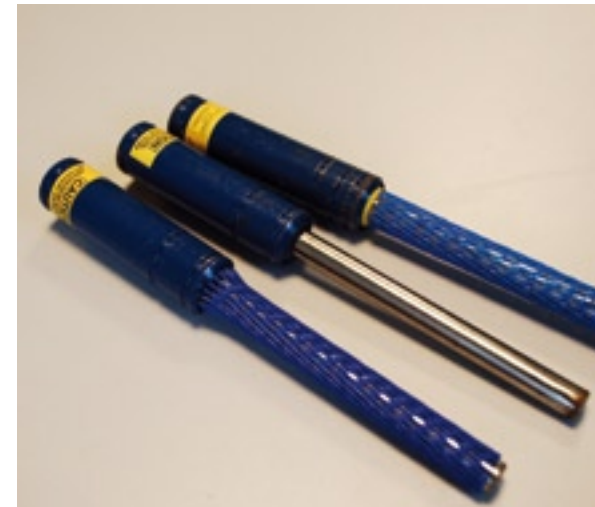
Drie gaspatronen voor het naadloze injectie-apparaat. Er zijn vijf verschillende. Ze bepalen de injectiediepte.
