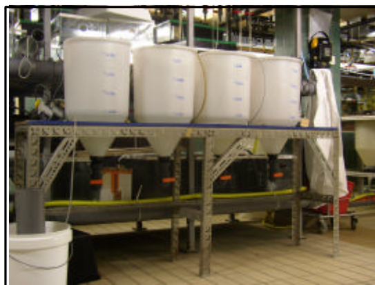
Figuur 8; Massakweekinstallatie voor het kweken van Brachionis plicatilis , gebruikt op het RIVO in IJmuiden
