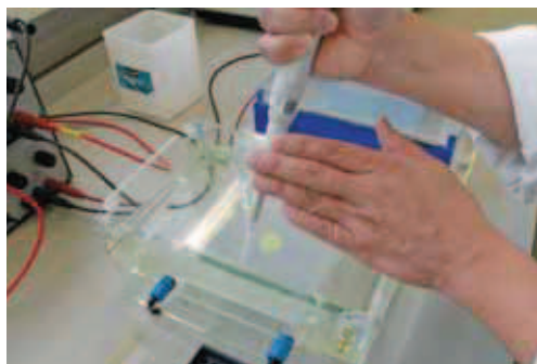
17. Monstertjes DNA worden met een pipet in de gaatjes van een gel gespoten. De gel ligt onder water in de glazen elektroforese-bak.
