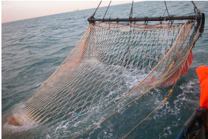
Fig.: 2 Grote mazenkap ARM-44, startuitvoering
