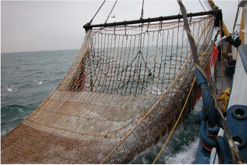
Fig.: 4 Grote mazenkap ARM-44, uitvoering 3.20 m verkort met zijstukken langs de naden
