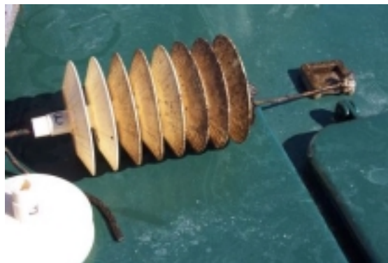
Figuur 3. Plaatsen van kunststof collectoren (buizen en hoedjes) in de derde week van het onderzoek.
