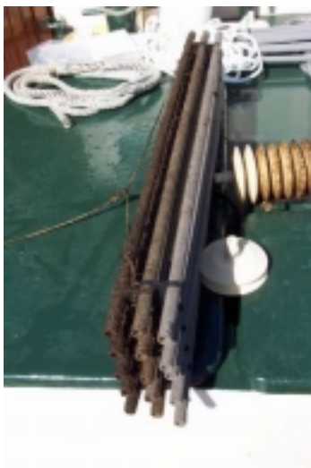
Figuur 3. Plaatsen van kunststof collectoren (buizen en hoedjes) in de derde week van het onderzoek.
