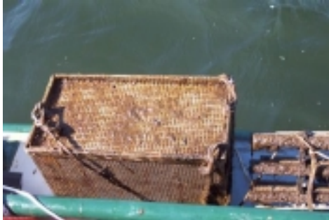
Figuur 2. Perspex plaatjes in roestvrijstalen kooi voor monitoring broedval.
