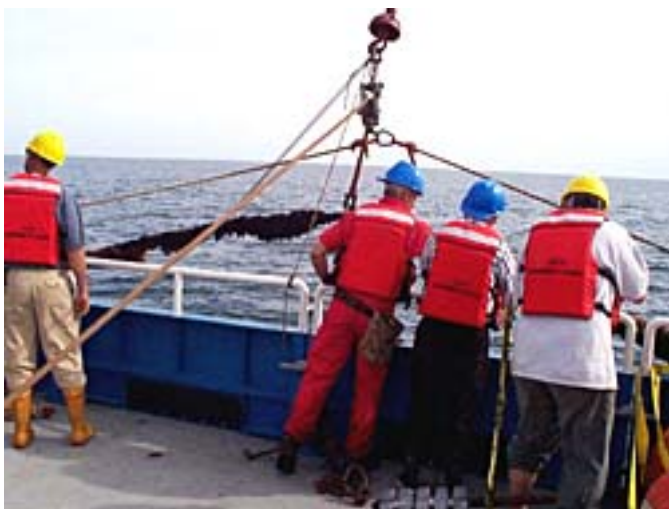
Figur 2.2. Inspectie van de longline na 8 1/2 maand op zee. De 3 cm dikke longline is sterk begroeid geraakt met mosselzaad en hydroïdpolypen. www.whoiedu
