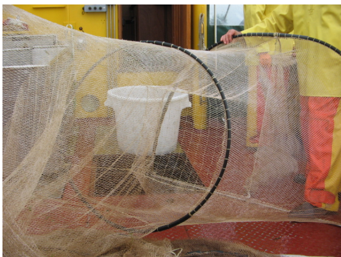
Figuur 3. Keerwant 85 mm (gestrekt) nylon voor de eerste keel, BU33.
