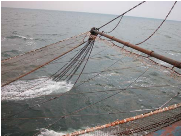
Fig.: 2 Grote mazenpaneel gebruikt in 12 m boomkor
