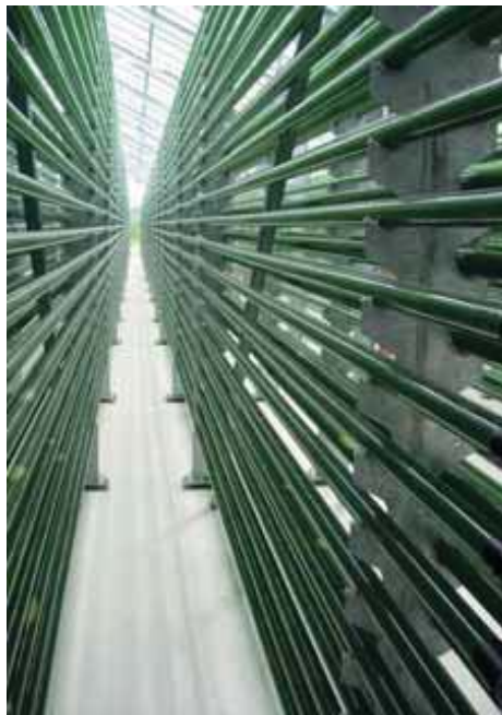
Buizenreactor voor de kweek van algen.
