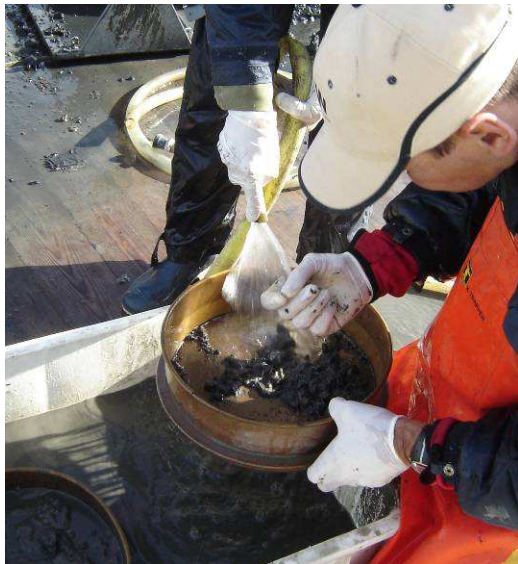
Figuur 4. De bovenste 10 cm van een boxcore wordt gezeefd met een zeef van 500 \mu\text{m} , waarbij de macrofauna overblijft.
