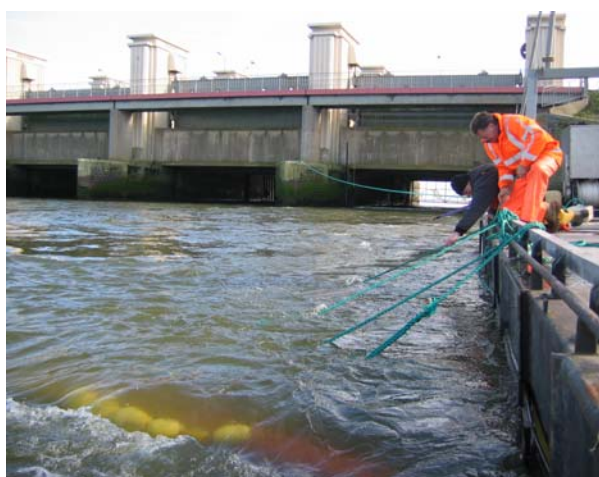
Foto 1. Bemonstering van uitspoelende vis via een spuijoker bij Kornwerderzand door beroepsvissers Manshanden en van Malsum. Vissen die de spuijoker passeren belanden in een fuik die de hele joker afdekt en worden naar de bun van het schip geleid (foto: Joep de Leeuw).
