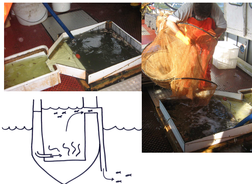
Figuur 3. Impressie vangstsoorteerder "Patrick Schilder": Water wordt continue onderin de bak gevoerd; aal zwemt doorgaans naar de bodem, schubvis wordt bovenaf meegevoerd en gaat overboord.
