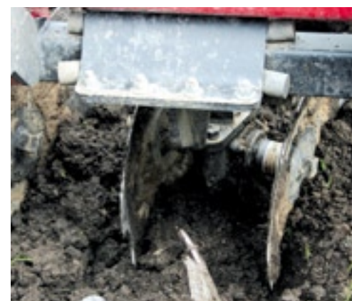
▲ De bolle, gekartelde schijven zijn onder een hoek geplaatst zodat ze agressief werken.
