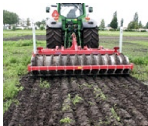
▲ De Sumo Trio maakt in één bewerking de grond nagenoeg zwart en laat de grond vlak achter.
