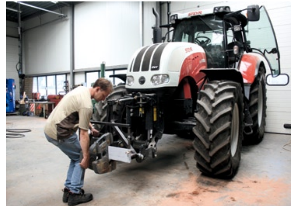
▲ Frontgewichten ophangen aan een zelfbouwframe: de universele frontgewichtendrager.
