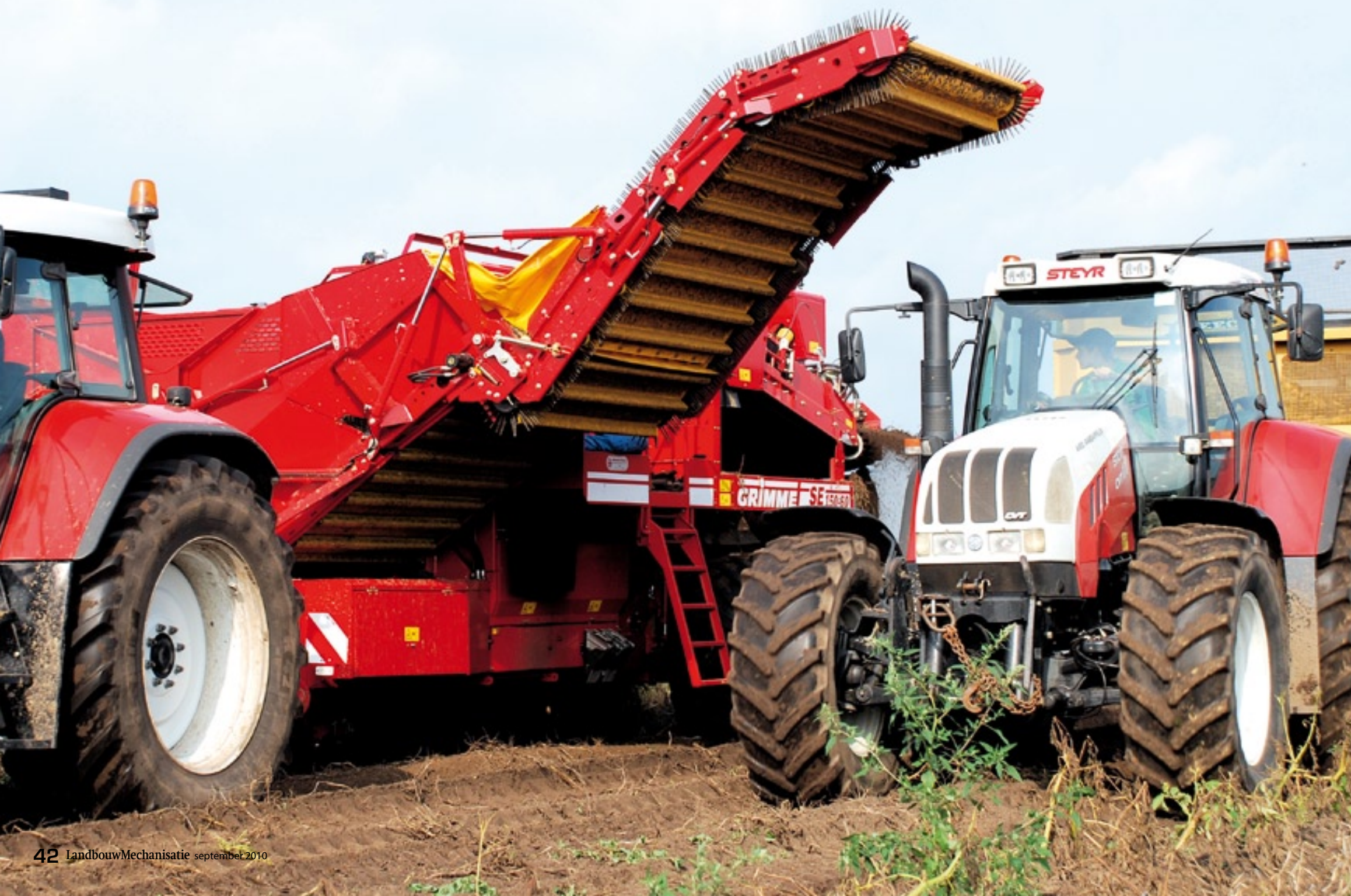
▲ Voor een hogere capaciteit is de eerste reinigingsband verlengd en de tweede verbreed.
