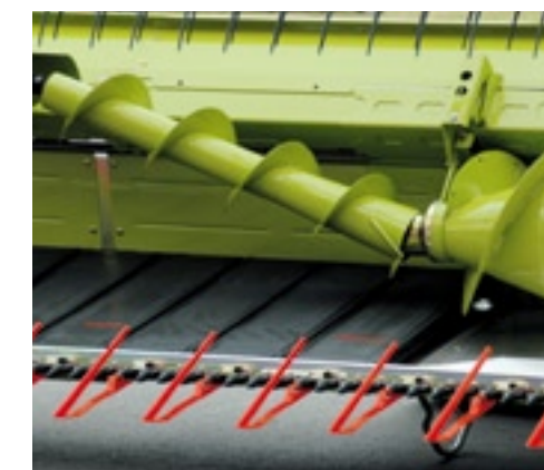
Het Maxflow maaibord is nu voorzien van extra vijzels om de invoer van het gewas te versnellen en zo de capaciteit te verhogen.
