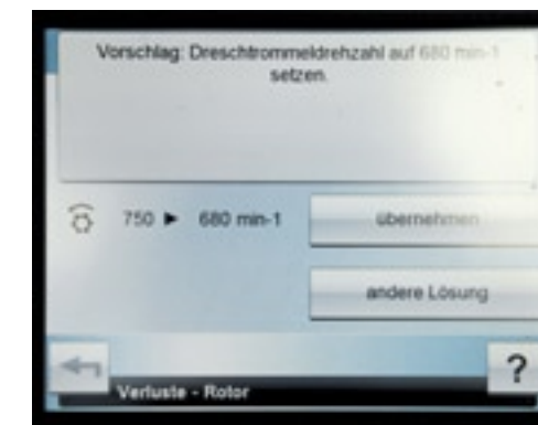
Na elke afstellingsactie meldt Cemos of de optimalisatie geslaagd is of niet.
