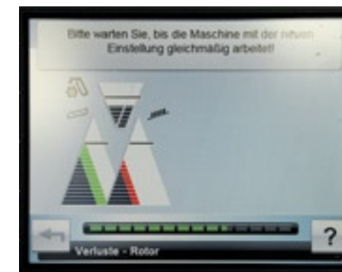
Cemos geeft via grafieken aan in hoeverre de afstelling verwijderd is van het optimum.
