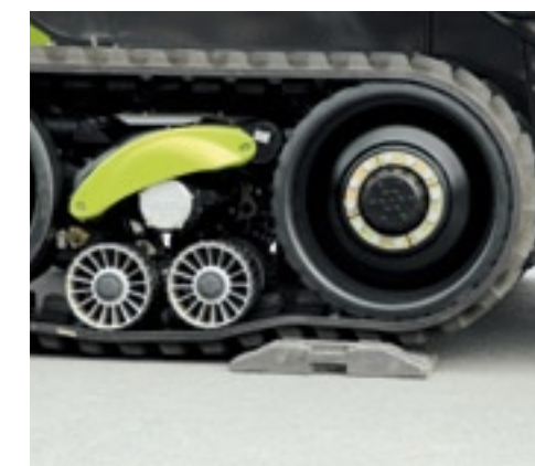
De wielen zijn in hun vering gekoppeld, evenals de looprollen: komt de ene omhoog, dan wordt de andere stevig aan de grond gedrukt.
