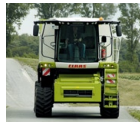
Met het geveerde Terra Trac rupsonderstel kan en mag de Lexion maaidorser nu comfortabel en veilig 40 km/h rijden op de openbare weg.
