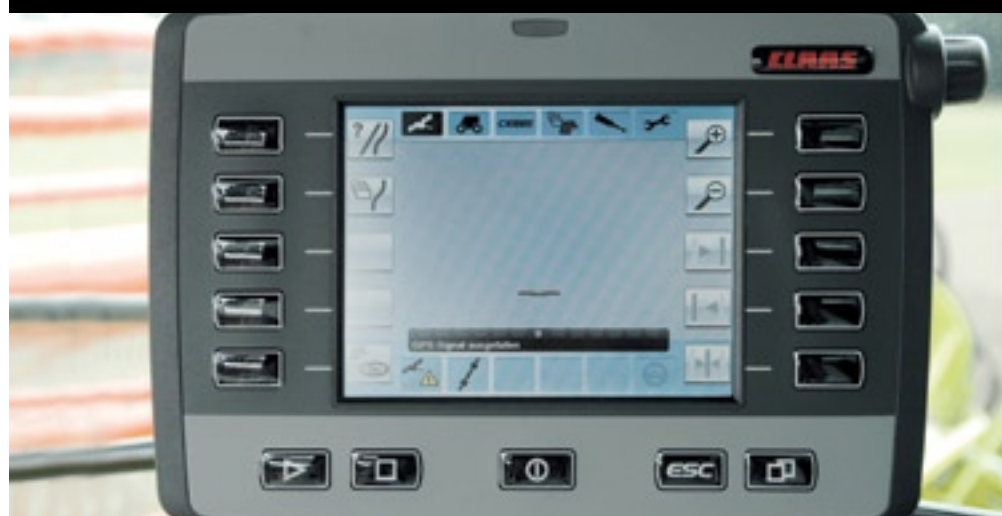
Het beeldscherm voor het optionele Telematics (voor service en logistiek) wordt door Claas nu ook gebruikt voor het eveneens optionele Cemos dat de chauffeur helpt bij een optimale afstelling.
