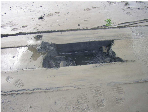
6. Gat dat achterblijft wanneer (in dit geval) het monstertuig na te zijn ingegraven verticaal uit de bodem wordt getild. In de praktijk wordt het tuig na het sluiten van de kleppen in voorwaartse richting uit de bodem getrokken.
