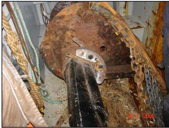
Figuur 10. Stelbouten Flybeam constructie.
