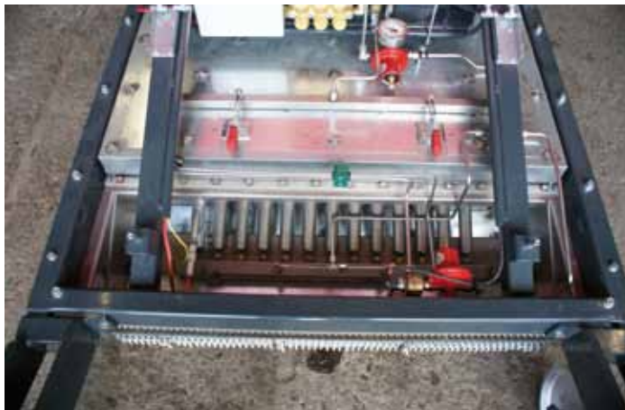
◀ Vooraan de branders en de verbrandingspijpen die hete lucht in de heteluchtkamer erachter jagen. Op de heteluchtkamer, achter de rode handvatten, zit de waterleiding voor de koudwaterinjectie in de stoomkamer.
