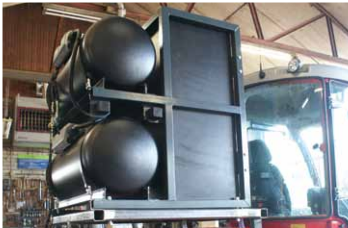
◀ Achter op de Antonio Carraro SP 4400 zitten op een apart frame de twee 90-liter-gastanks met daarvoor de 300-liter-watertank. Aan de andere kant zit een kijkglas voor het waterpeil.
