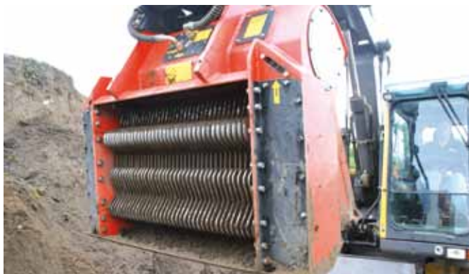
◀ De DSB 2-12X15-zeefbak is 1,20 meter breed en heeft twee horizontaal geplaatste drums met vijfpunts sterrenschijven.
