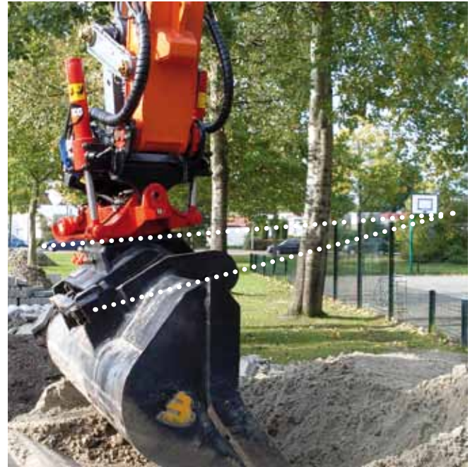
De H-hoek meet u door de draaikrans horizontaal op nul graden zetten. De hoeklijn verkrijgt u door over het hart van de twee ophangpunten van de snelkoppeling een lijn te trekken naar het snijpunt van de lijnen.
