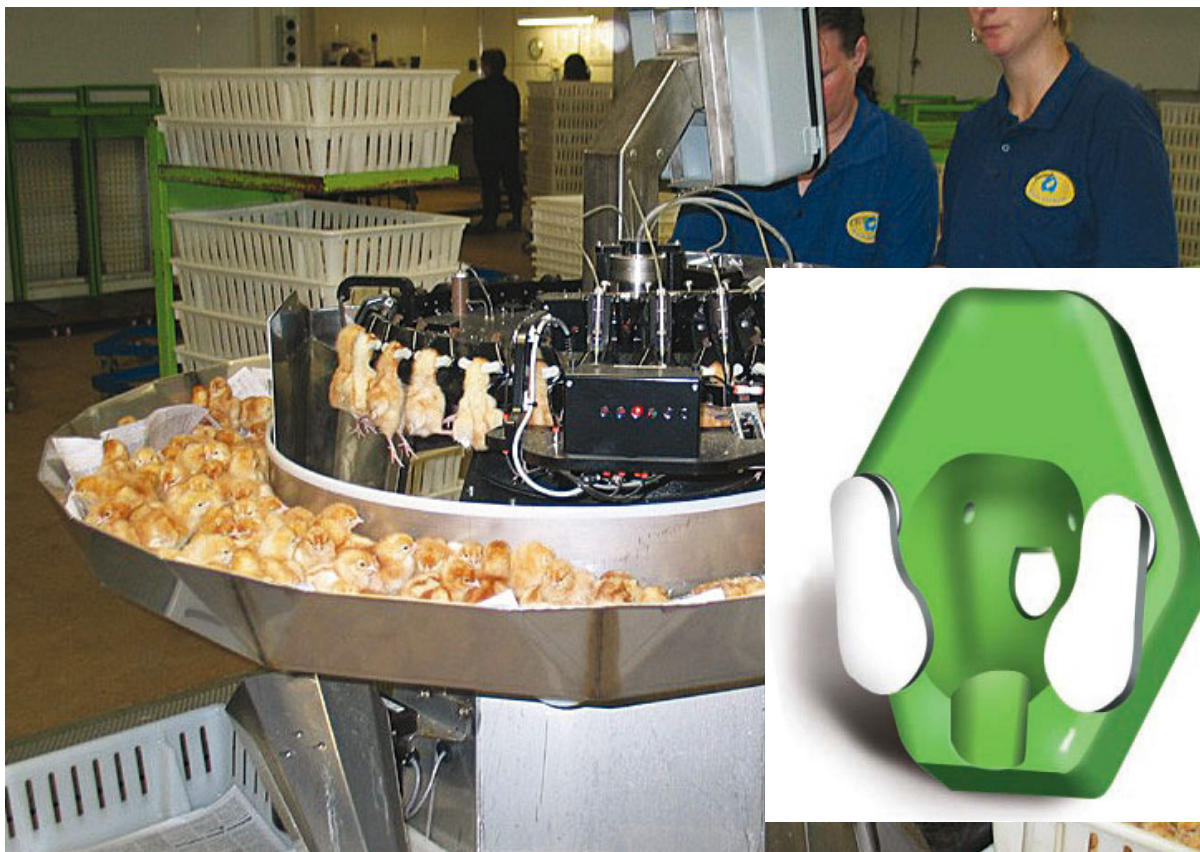
Foto 3 Infrarood snavelbehandelingsrobot (Foto SARDI, AUS)
