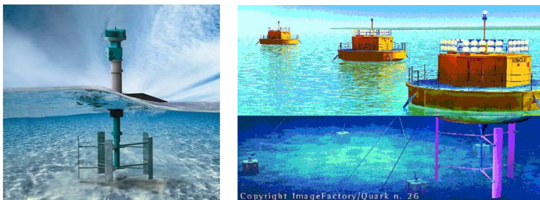
Figuur 5.6: links: voostelling van de EnCurrent turbine [3]; rechts: voorstelling van de Kobold turbine [4].
