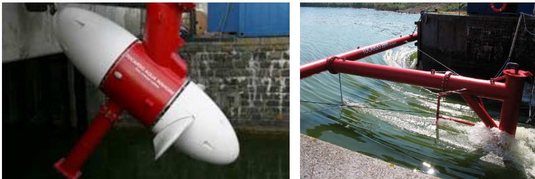
Foto 4.1: voorstelling van de Tocardo T50 turbine [2].
