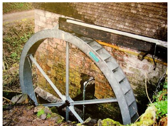
Figuur 3.11: principe van een bovenslaand waterrad. Links: doorsnede van een bovenslaand waterrad, rechts: foto van een bovenslaand waterrad in werking [3,6].
