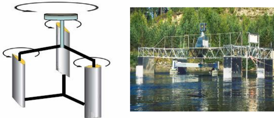
Figuur 5.5: voorstelling van de WPI-turbine. Links: Schematische voorstelling; rechts: prototype [6].
