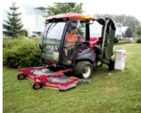
Met de machine kun je strak langs obstakels maaien. Wordt het te krap, dan klap je gewoon één of meerdere zijdekken op.
