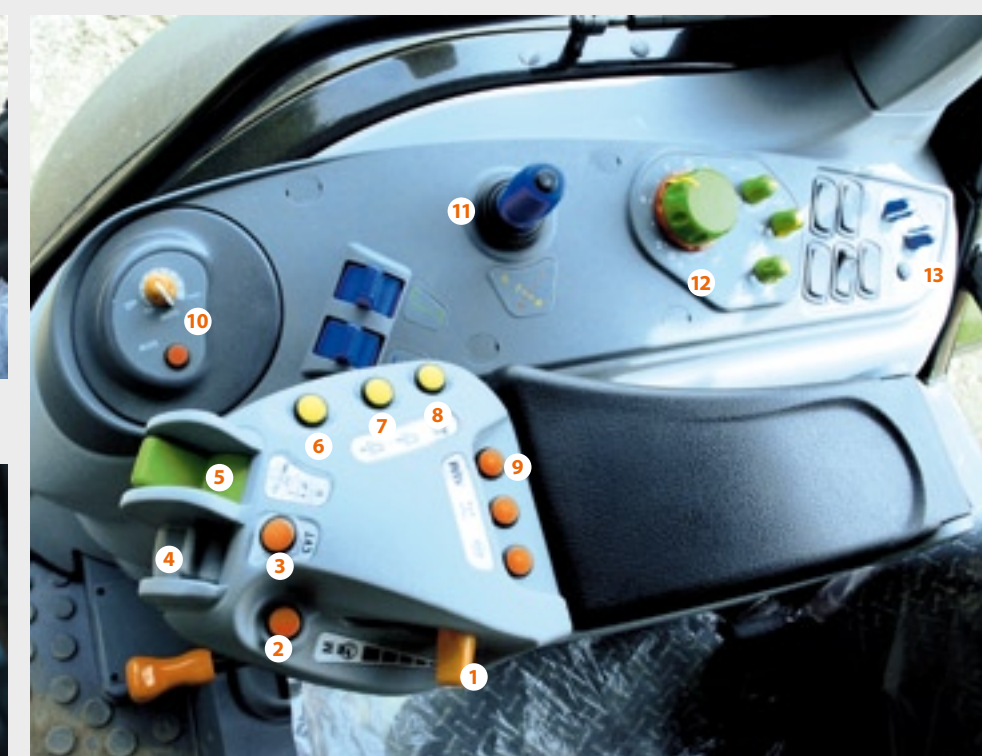
De traploze transmissie bedien je met een paar oranje gekleurde knoppen in de armleuning en met een draaiknop op het rechterconsole. 1: handgas; 2: geheugen motortoerental; 3: cruisecontrol; 4: flipper rijsnelheid; 5: flipper hef; 6: frontaftakas; 7: achteraftakas; 8: automatische pto; 9: bediening kopakkermanagement; 10: draaiknop eco/power-stand; 11: bediening hydrauliek; 12: bediening hef; 13: doorstroomtijd hydrauliek.
