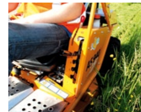
De dikke hendel is voor de maaihoogte. Met de rode hendel schakel je het maaidek in.
