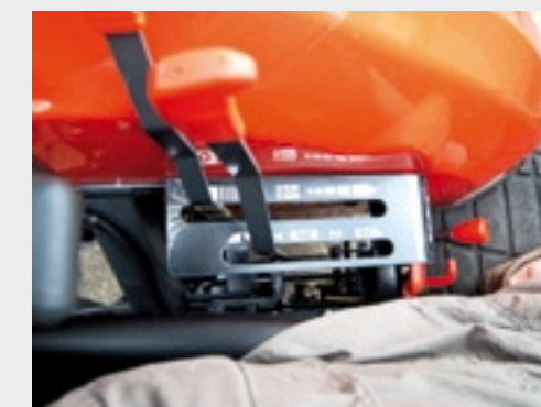
Links naast de stoel zitten twee hendels voor de cruisecontrol en de hydrostaat.
