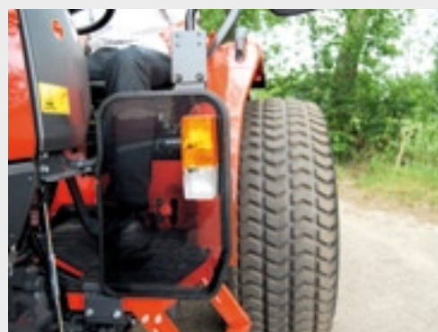
Voor de pedalen zitten doorzichtige spatschermen met geïntegreerde lampen.
