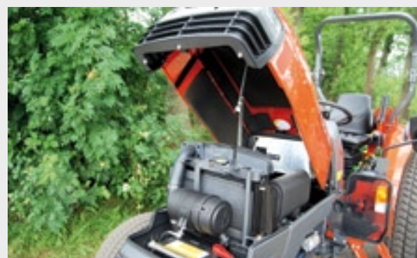
De motorkap gaat in een geheel open en valt vanzelf in de steun.
