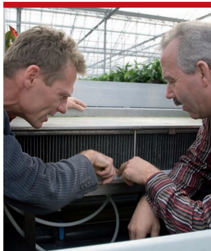
Feije de Zwart (links) en Stef Huisman bekijken de FiWiHEX (Fine Wire Heat Exchanger) bestaande uit kilometers fijn geweven koperdraad met daarin dunne buisjes waar water doorheen stroomt.
