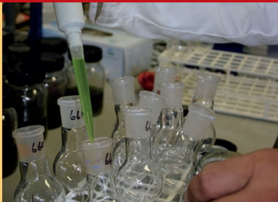
Een afgemeten hoeveelheid van het oplosmiddel met de eventueel opgeloste restanten van gewasbeschermingsmiddelen gaat in een apart kolfje...
