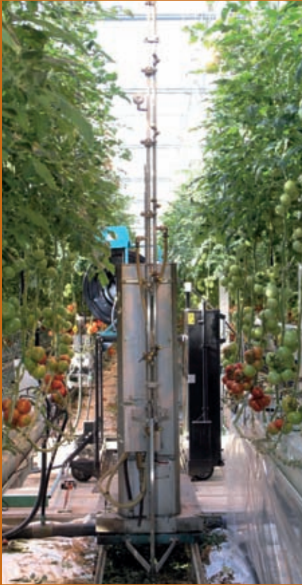
Een spuitrobot zonder luchtondersteuning met de gele O2-spleetdoppen in werking. Op de linkerfoto begint de spuitrobot met spuiten, op de middelste foto is goed het smalle ellipsvormige spuitbeeld te zien en de rechterfoto geeft een mooi beeld van de goede vloeistofverdeling.
